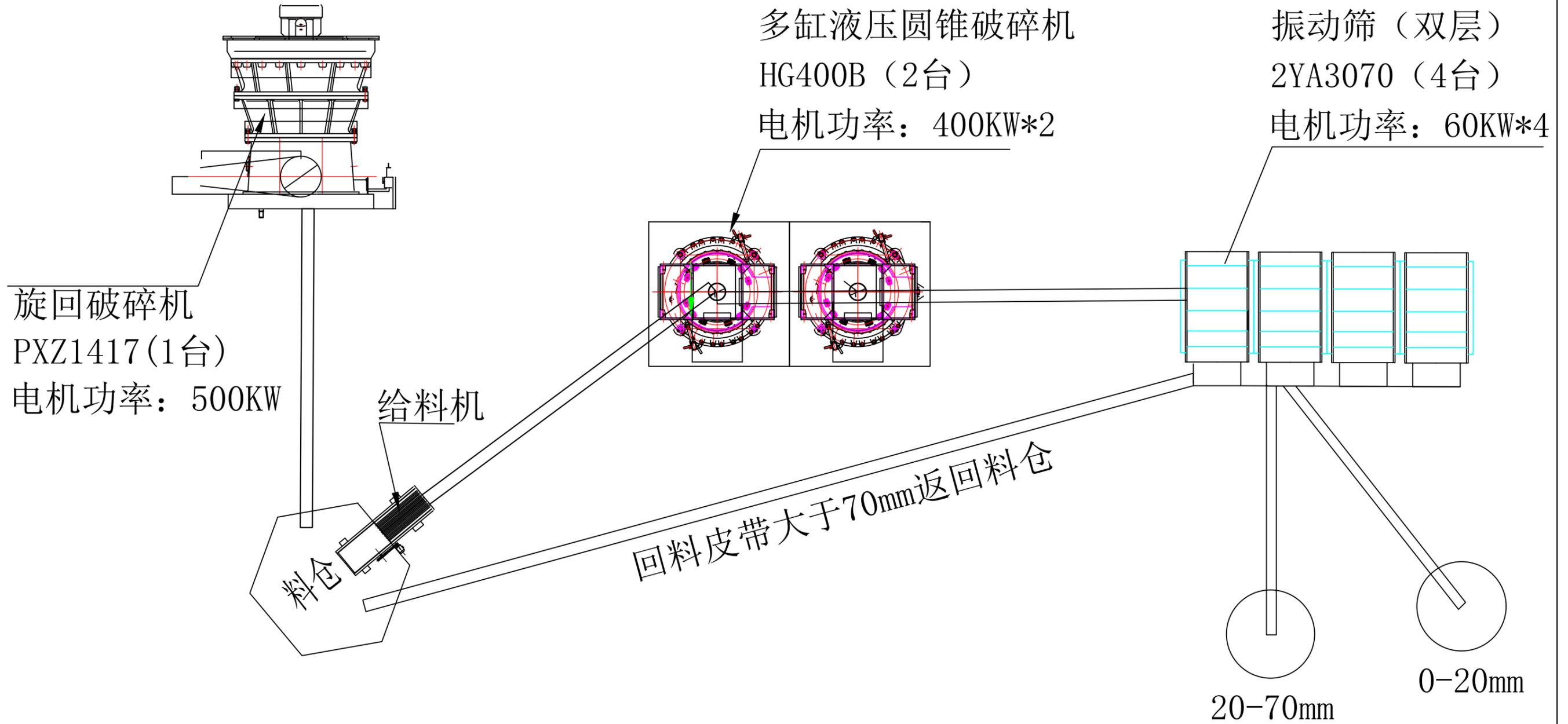
备注：破碎设备总装机功率为1540KW(不含皮带)
